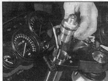
3.10e . . . then install top bolt
