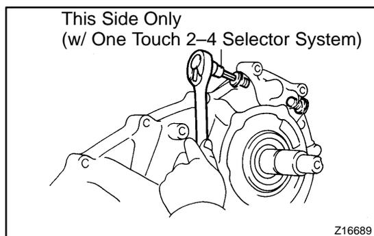
**16. REMOVE STRAIGHT SCREW PLUG, SPRING AND LOCKING BALL**
