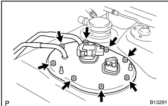
3. REMOVE FUEL PUMP AND SENDER GAUGE ASSEMBLY FROM FUEL TANK
