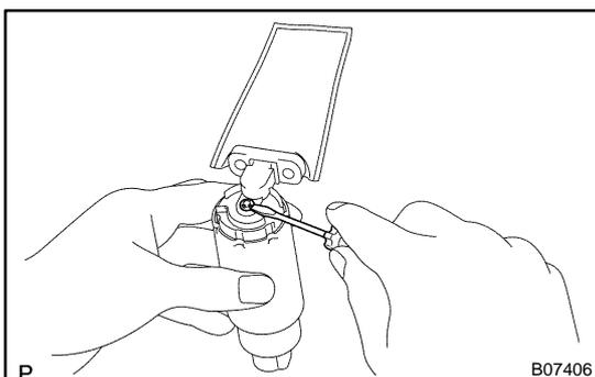
5. REMOVE FUEL PUMP FILTER FROM FUEL PUMP
