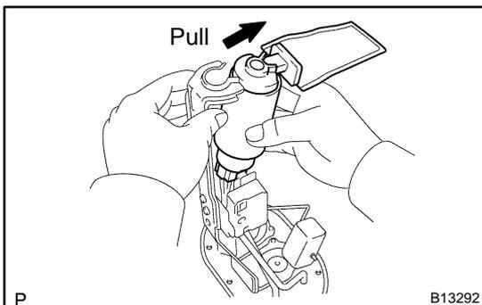
4. REMOVE FUEL PUMP FROM FUEL PUMP BRACKET
