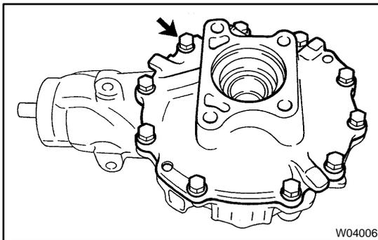
**13. REMOVE SIDE BEARING RETAINER**
