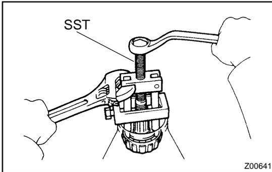
**12. REMOVE REAR BEARING AND BEARING SPACER**
