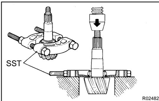
**16. REMOVE DRIVE PINION FRONT BEARING**
