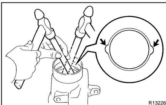
**17. REMOVE DRIVE PINION BEARING OUTER RACES**
