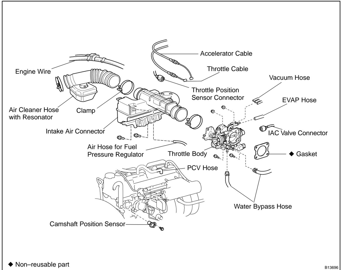
IGNITION (2RZ-FE, 3RZ-FE) - CAMSHAFT POSITION SENSOR
