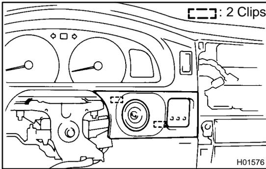
**8. REMOVE STARTER SWITCH BEZEL**
