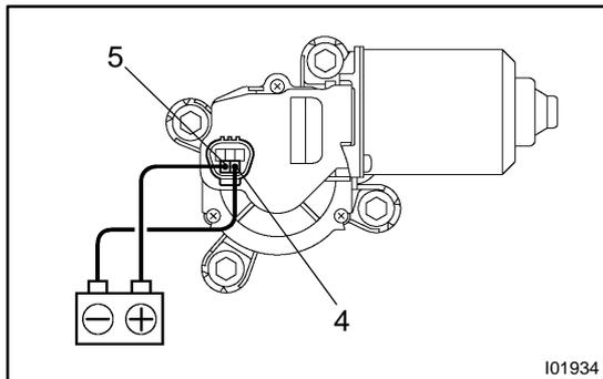
**4. Low Speed: INSPECT WIPER MOTOR OPERATION**
