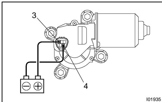
**5. High Speed: INSPECT WIPER MOTOR OPERATION**
