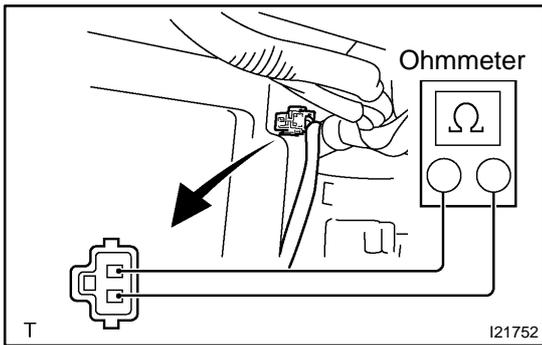
5. INSPECT PRESSURE SWITCH OPERATION
