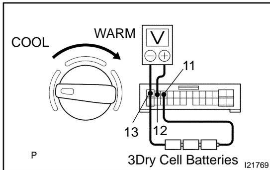
**8. INSPECT TEMPERATURE CONTROL SWITCH OPERATION**
