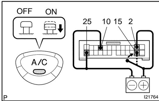
**6. INSPECT DIMMING OPERATION**
