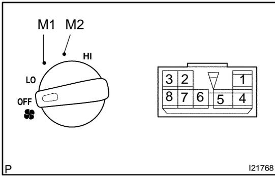
**9. INSPECT BLOWER SPEED CONTROL SWITCH OPERATION**
